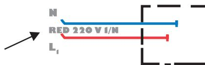
**GRÁFICO 39.** Se observa que los cables de la red van directamente a la caja de derivación.
