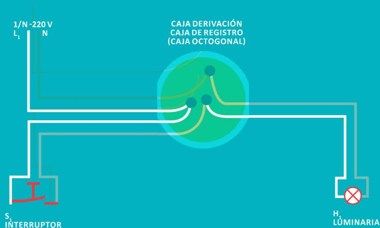
**GRÁFICO 35.** Muestra la instalación real de una luminaria con su respectivo interruptor y demás accesorios (caja octogonal y conductores).
